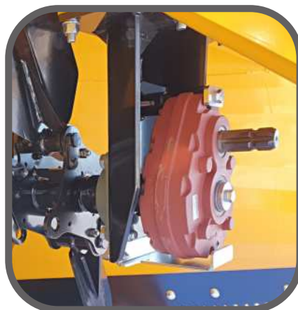
Alennusvaihte tukilaakereilla (mallit 241, 242, 260R, 255LA ja 273LA)
