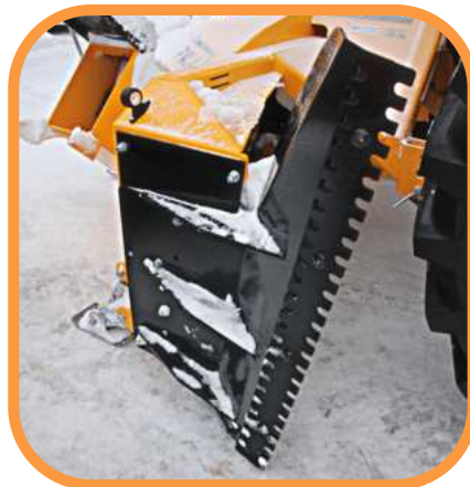
Vallileikkuri 500HB Hardox terällä (malleihin 241, 242 ja 260R)
