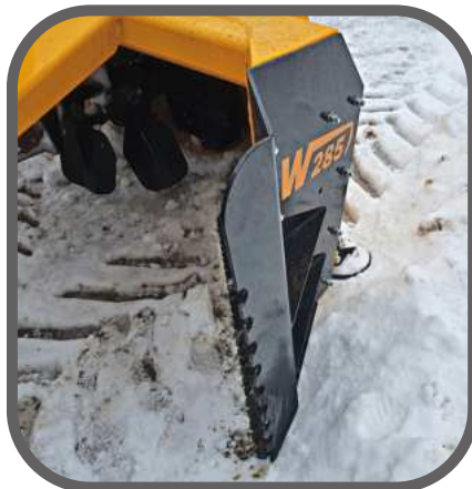
Pultattava vahvistettu päätylevy (mallit 241 ja 242)
