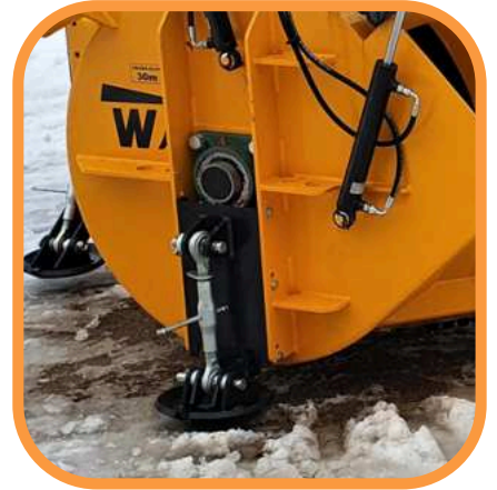
Säädettävät tukijalaket 500HB Hardox (2024 syksystä lähtien kaikissa malleissa vakiona)
