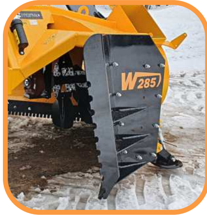
Levennyssiipi 285 mm vasen tai oikea (malleihin 241 ja 242)
